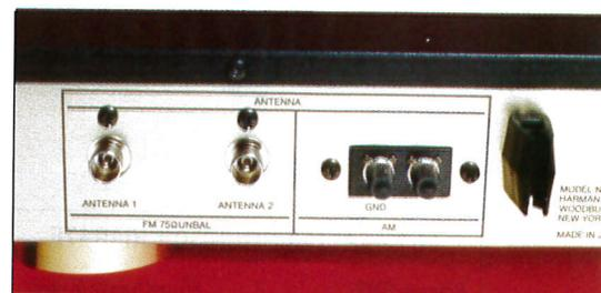
**Al tuner Harman Kardon TU 9600 è possibile collegare due distinte antenne FM. Una buona idea.**
